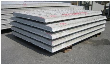
Die Lagerung und der Transport der vorgespannten Elementdecke VSE müssen sorgfältig erfolgen, um Beschädigungen zu vermeiden.
